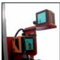
Sensor láser Sensor láser para la fila superior para detectar la presencia de cajas en la parte superior de las placas
